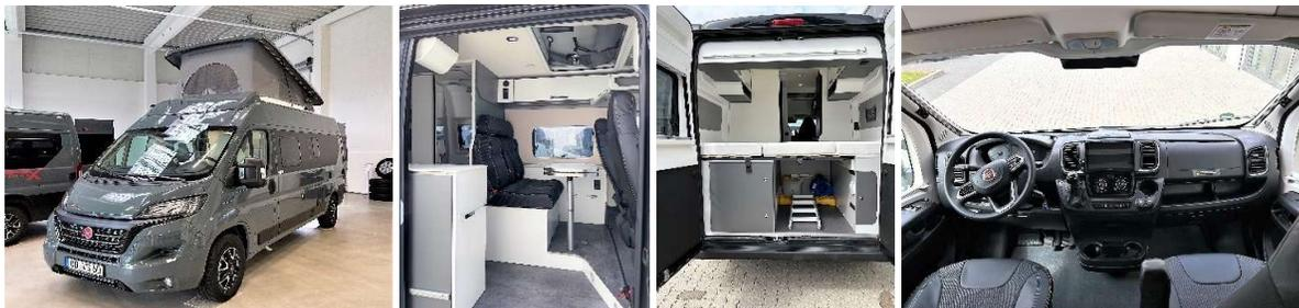
**Yucon 60 B Aufstelldach** für maximal 3 Personen - Das Fahrzeug hat eine Länge von 6 Metern, hinten ein Querbett für zwei
